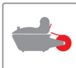
Установите рулон с пленкой на кронштейны (12) и расправьте ее таким образом, чтобы ее края были симметричны относительно резиновых роликов. Удерживая нажатым рычаг отпуска прижима (9), продвиньте пленку вглубь до упора.
