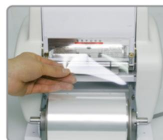
1) Установите рулон с пленкой на кронштейны (12) и расправьте ее таким образом, чтобы ее края были симметричны относительно резиновых роликов.
