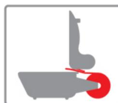
2-3 раза опустите и поднимите крышку (2) – пленка автоматически станет доступной для вытаскивания.
