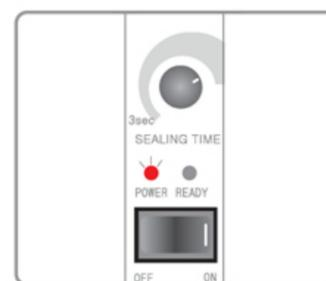
4) Включите питание, установив выключатель питания (6) в положение «ON». После этого должен включиться светодиод, индицирующий включение питания.
