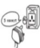
После прерывания подачи электроэнергии извлеките вилку силового шнура из розетки. Каким бы коротким интервал отсутствия энергопитания ни был, выждите не менее 5 минут, затем включите вилку в розетку и запустите аппарат снова.
