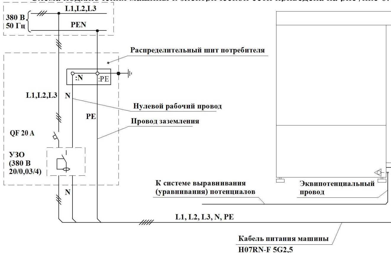
Рисунок 6 – Схема подключения к электрической сети
