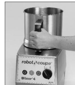
2) Поворачивайте ручку вправо до тех пор, пока выступы блока двигателя не войдут хорошо в предусмотренное для них место. Магнитный стержень соединен с блоком двигателя и находится перед вами.
