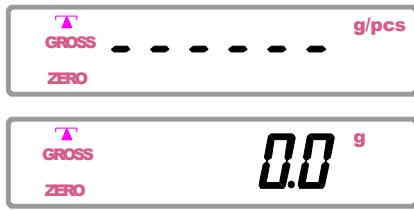
В заключение на дисплее устанавливается режим взвешивания с нулевым показанием и включаются указатели **ZERO**, **GROSS**, **g** и стабилизации **▲**.
