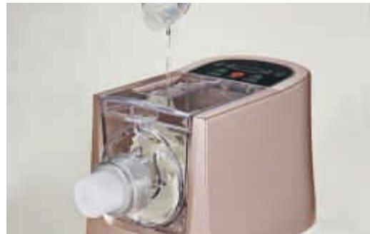
**Внимание:** отверстия в крышке не должны перекрываться или быть чем-то заблокированы. Вода из емкости должна постепенно просачиваться вниз.
