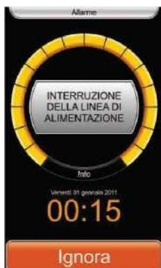
В случае исчезновения электропитания, если аппарат находился в процессе выполнения цикла, то при возобновлении подачи электричества на экране отобразится аварийный сигнал исчезновения электропитания. Цикл автоматически возобновляется с того момента, на котором он был прерван. Центральный экран показывает время, в течение которого аппарат находился без электроснабжения.
