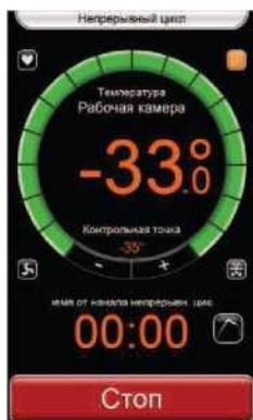
В режиме НЕПРЕРЫВНОГО ЦИКЛА температура воздуха в камере поддерживается на уровне  $-35^{\circ}$  (этот параметр можно изменить). Разморозка аппарата заблокирована для того, чтобы обеспечить непрерывность работы. Непрерывный цикл используется в производстве кондитерских изделий и хлеба для заморозки теста и блокировки процесса брожения, а также в производстве мороженого для быстрого достижения идеальной температуры хранения.
