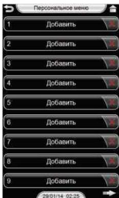
При нажатии на кнопку ПЕРСОНАЛЬНОЕ МЕНЮ отображается меню из 9 кнопок. Каждой кнопке можно присвоить выполнение определенного цикла. При нажатии на нее запускается соответствующая программа.
