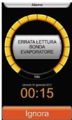
При ошибке чтения датчика испарителя или его повреждении на экране отображается аварийный сигнал об ошибке чтения датчика испарителя.
