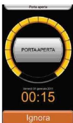
Если дверь открыта в течение более 10 секунд, на экране появляется предупреждение об открытой двери, сопровождающееся звуковым сигналом. Рекомендуется как можно реже открывать дверь в ходе выполнения циклов.
