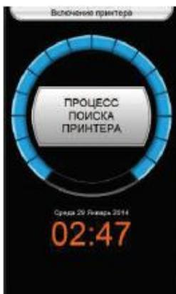
Для того чтобы установить новый принтер, необходимо настроить серийный адрес принтера bluetooth. Проводится поиск нового подключенного принтера, чей адрес используется по умолчанию для последующей печати.
