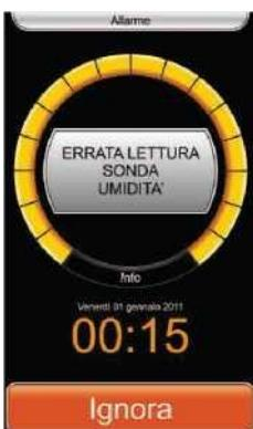
При ошибке чтения датчика влажности или его повреждении на экране отображается аварийный сигнал об ошибке чтения датчика влажности.
