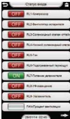
Нажмите на кнопку **СОСТОЯНИЕ ВХОДОВ**. В квадратах изображены все входы с указанием состояния (вкл/выкл) или параметр работы. Вы можете узнать показатели всех зондов аппарата. Данная функция предназначена для облегчения технического обслуживания аппарата специально обученным персоналом.
