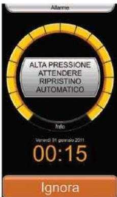
Если давление в холодильном контуре превышает максимальное предусмотренное значение, то на экране появляется соответствующее предупреждение. Если аварийный сигнал не выключается, обратитесь в службу технической поддержки.
