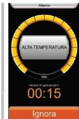
Если уровень температуры датчика камеры или игольчатого зонда превышает 100°C, включается аварийный сигнал «Высокая температура». Как только температура и датчика, и зонда опускается ниже аварийного уровня, аппарат возвращается обратно в режим шокового охлаждения.
