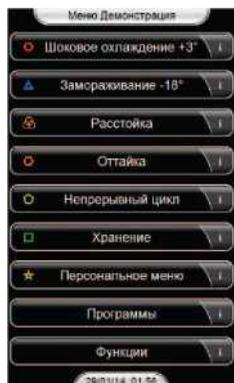
Комбинируя параметры температуры и вентиляции, система позволяет осуществлять разморозку продуктов быстрее, чем при использовании обычного холодильника. Прямо из главного меню (в режиме «Ресторация») или из меню «Функции» (в режиме «Кондитерские изделия») нажатием с соответствующей кнопки можно запустить один из способов разморозки в зависимости от типа продукта (овощи, красное мясо, белое мясо, рыба, тесто).
