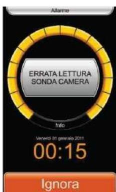
При ошибке чтения датчика камеры или его повреждении на экране отображается аварийный сигнал об ошибке чтения датчика камеры.
