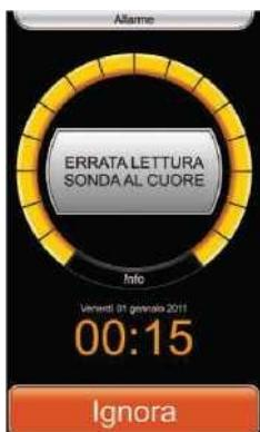
При ошибке чтения игольчатого зонда или его повреждении на экране отображается аварийный сигнал об ошибке чтения игольчатого зонда.
