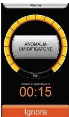
В случае поломки системы увлажнения на экране появляется окно **Аномалия в работе увлажнителя**.
