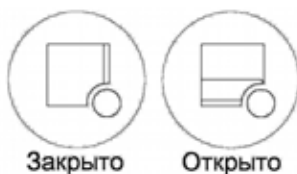
Рис.4. Положения фиксаторов защитной решетки вентилятора
