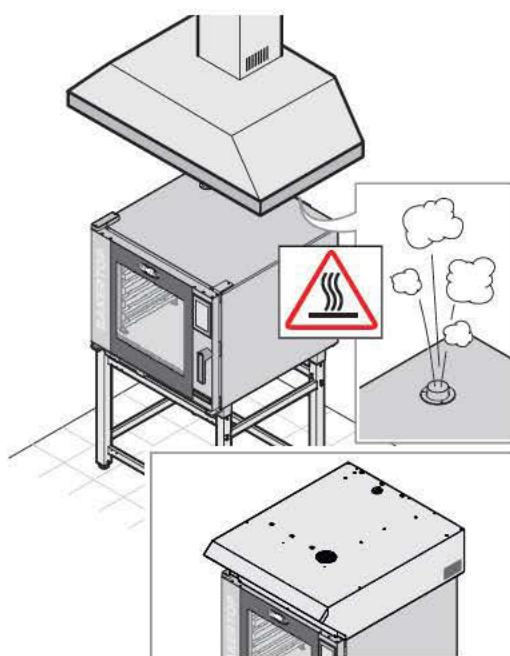
Через дымоотводы отводятся дым и запахи, поступающие из рабочей камеры, и отработавшие газы. Их отвод может осуществляться различными способами: выбрать соответствующий номинальной мощности устанавливаемого устройства и придерживаться национальных/местных норм страны назначения.
