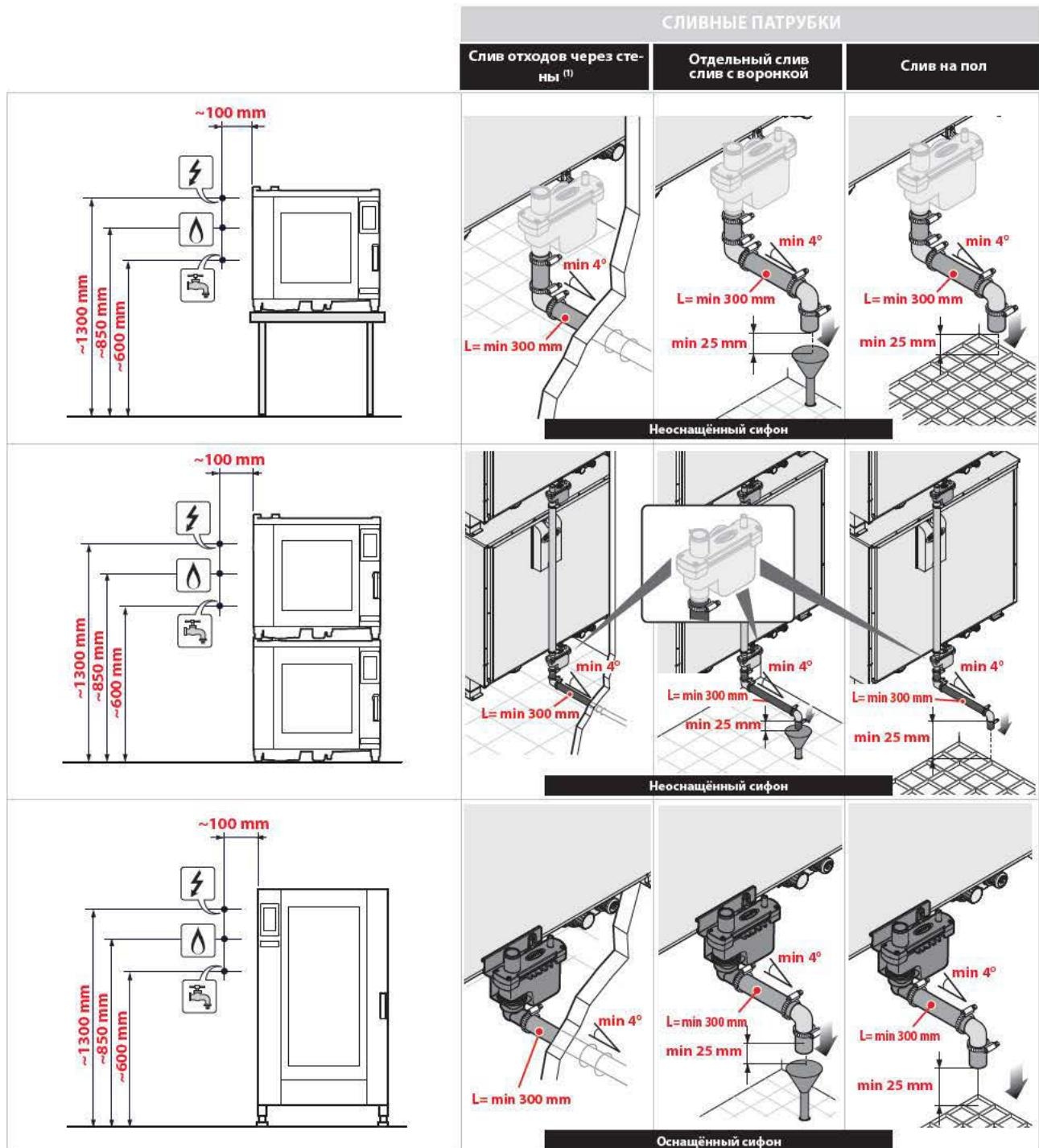
(1): Выход при сливе из стены должен иметь воздушный зазор не менее 25 мм.
