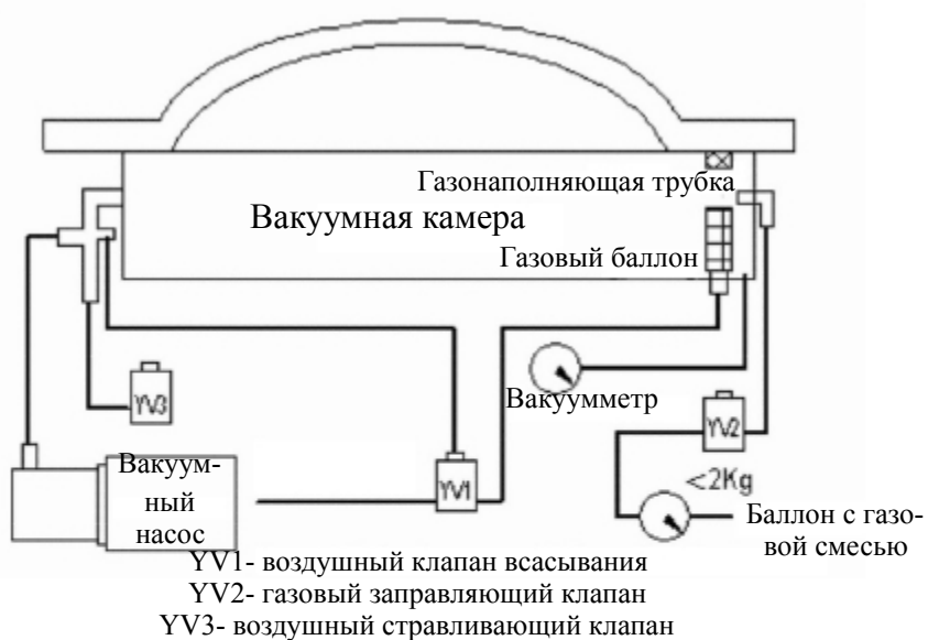
Схема вакуумного упаковщика с системой газации
