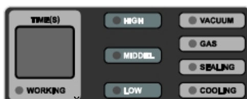
Рисунок 4.3 - Расположение таймера и индикаторов панели управления
