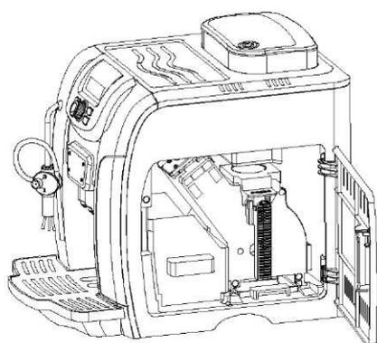
5. Возьмите заварочный блок за ручку. Установите на исходное место. Убедитесь, что заварочный блок правильно размещен на месте с характерным щелчком, после чего установите бункер для отходов. В завершение, закройте дверцу.
